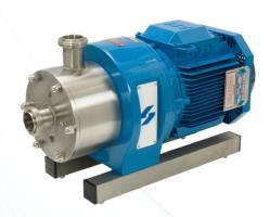
シルバーソンミキサーのローターが生み出す先端速度とそれに伴うせん断力は同種のミキサーの中でもトップクラスを誇っており、プロセスの時間を最大90%も短縮することが可能になり、細粒化、乳化、溶解、凝集塊の再分散の工程等に優れた役割を果たします。最大200,000L/時の自吸能力を持つ大容量ユニットもご用意しております。
